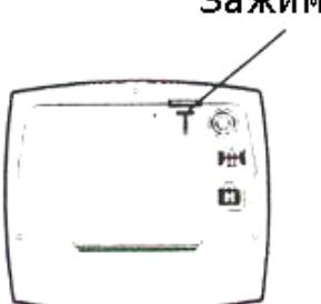
Электронный модуль предназначен для управления процессом регенерации. При замене контроллера убедитесь в том, что модели контроллеров совпадают.
