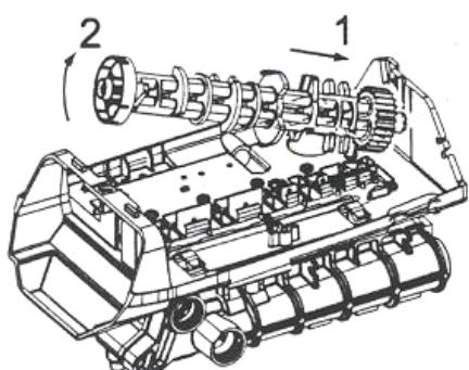
Для того, чтобы снять вал:
