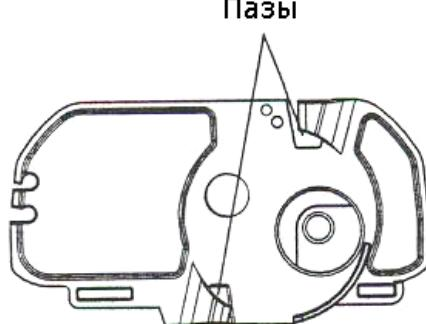
1. Установите двигатель так, чтобы зубья передачи вошли в зацепление с зубьями вала. Возможно, вал придется слегка провернуть.
