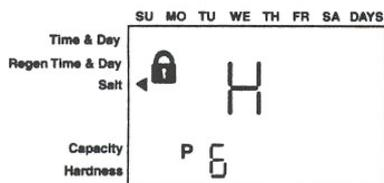
**High Salt** – такая настройка позволяет системе работать с наибольшей эффективностью. Она используется в установках с высокой жесткостью исходной воды, большим водопотреблением или для обеспечения гарантированного постоянного и глубокого умягчения воды. Обозначается буквой «H»
