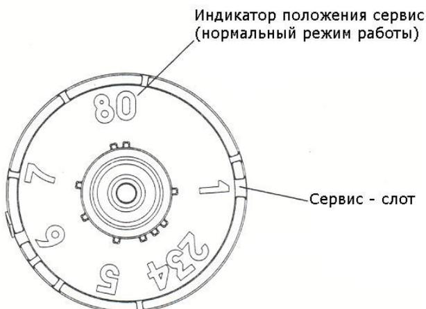
Прорези сделаны специально для включения/выключения оптического датчика.
