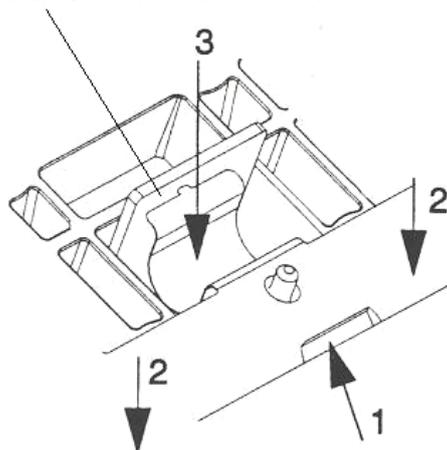
8. Другой рукой с помощью отвертки по очереди заведите за пластины пилотных дисков. Пружина должна встать выступом в отверстие на пластине.
