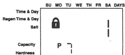
отображается в килограммах жесткости по CaCO<sub>3</sub> – соответственно количеству ионов, которые могут быть замещены в течение одного цикла работы. Данная размерность соответствует стандарту, принятому в большинстве стран мира. Емкость, выраженная в килограммах, отображается только при настройке контроллера. В контроллере серии 740 значение емкости нельзя менять.
