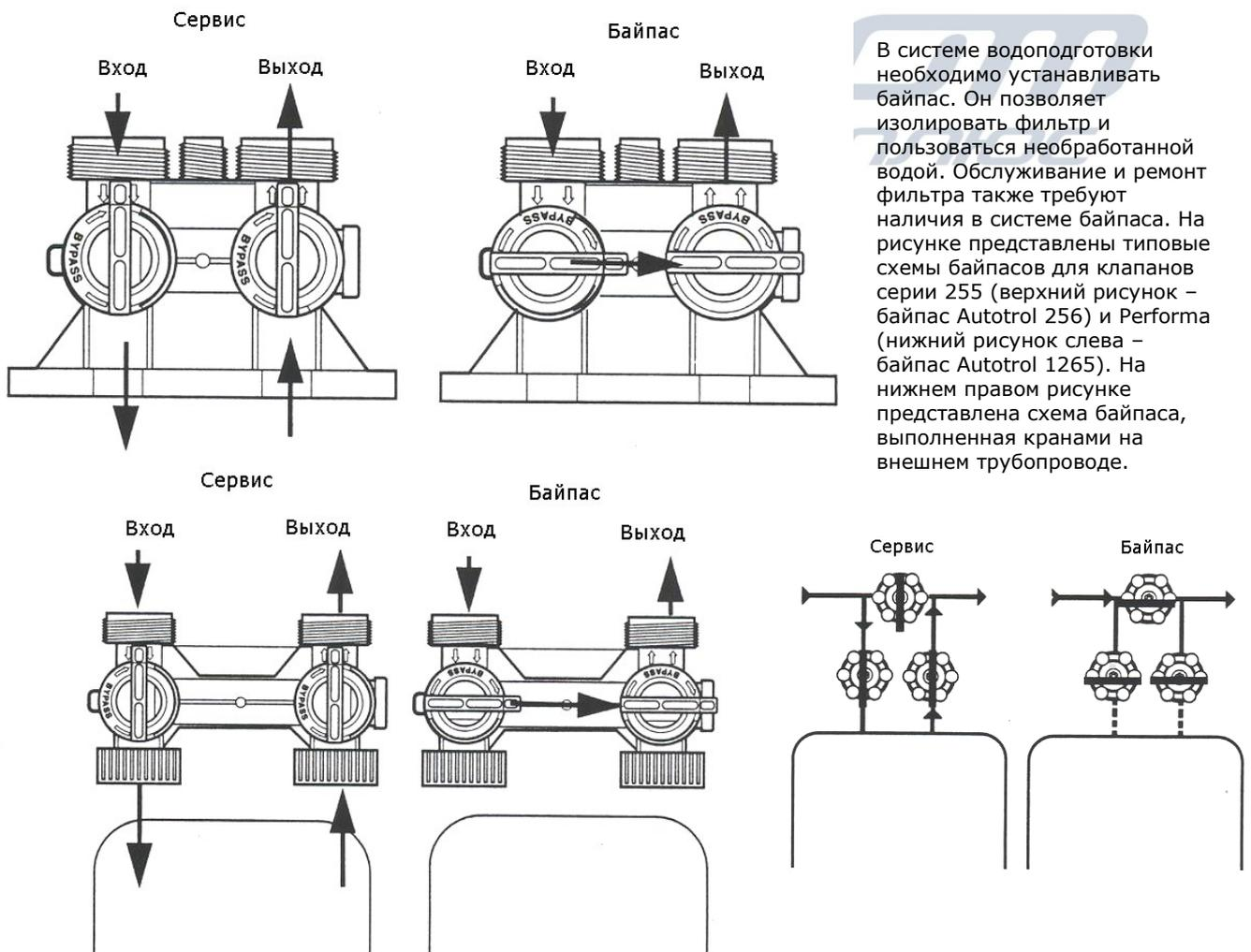
В системе водоподготовки необходимо устанавливать байпас. Он позволяет изолировать фильтр и пользоваться необработанной водой. Обслуживание и ремонт фильтра также требуют наличия в системе байпаса. На рисунке представлены типовые схемы байпасов для клапанов серии 255 (верхний рисунок – байпас Autotrol 256) и Performa (нижний рисунок слева – байпас Autotrol 1265). На нижнем правом рисунке представлена схема байпаса, выполненная кранами на внешнем трубопроводе.
