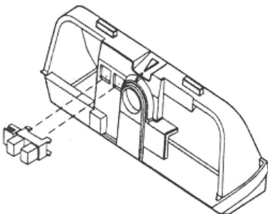
Оптический датчик закреплен на верхней пластине. При вращении вала диск с прорезями периодически перекрывает луч оптического датчика в заданной комбинации – это дает возможность отследить угловое положение вала в любой момент времени и передать данные о нем в процессор контроллера.
