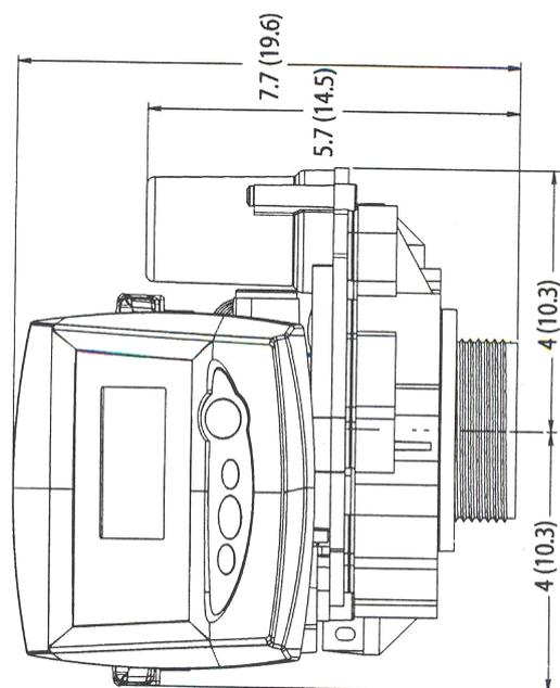
**Клапан серии 255 с монтажным комплектом без крышки**
