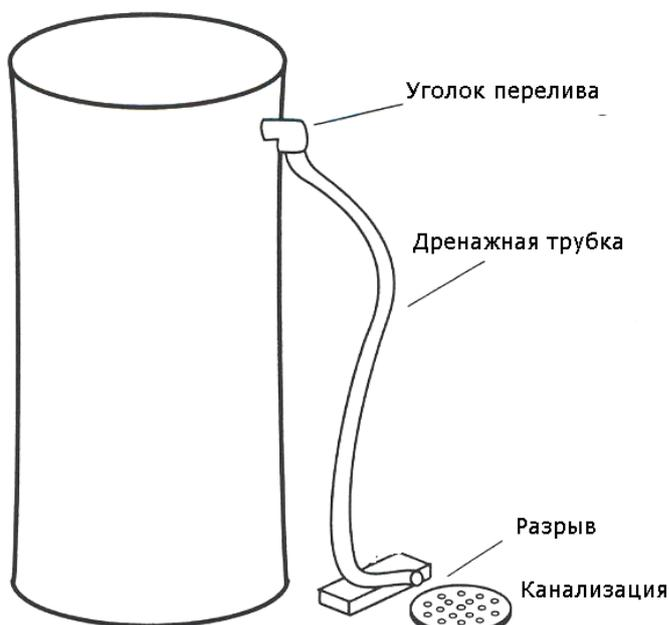
При неисправности системы, в случае переполнения реагентного бака, излишек воды может сливаться в канализацию. Для этого используется специальный уголок перелива, врезаемый в стенку реагентного бака.
