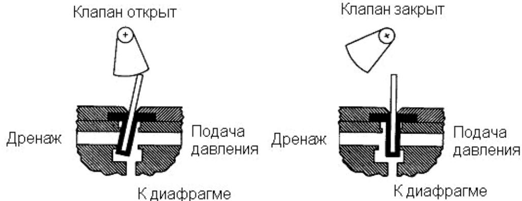
Рис. 4.1 Принцип работы пилотного клапана
