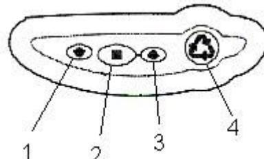
**Заметка:** если ни одна из кнопок не нажимается в течение 30-ти секунд, контроллер возвращается в нормальный режим работы.
