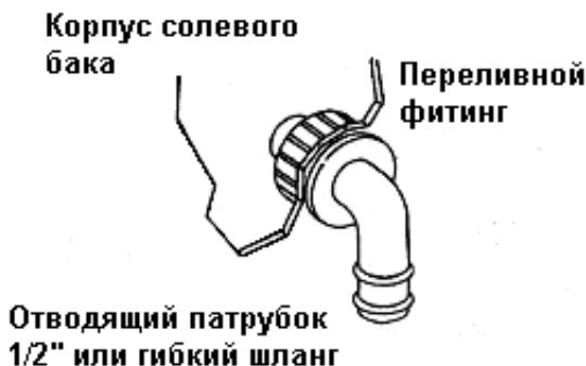
**Внимание:** категорически запрещается соединять дренажную линию клапана управления фильтра и переточную линию бака-солерасторовителя!
