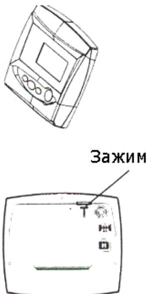
Электронный модуль предназначен для управления процессом регенерации. При замене контроллера убедитесь в том, что модели контроллеров совпадают.
